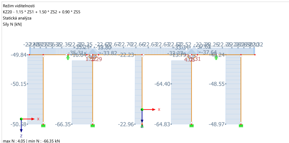
Obr. č. 9. Vrcholová vaznice a sloupky – maximální Normálové síly N_{ed} [kN]
