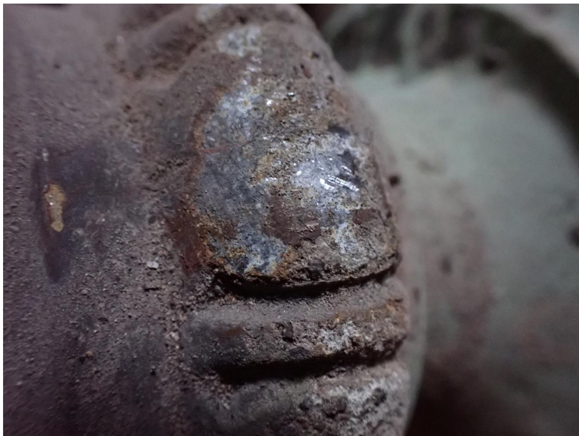
zinkový odlitek na hrotnici opatřený barvo
