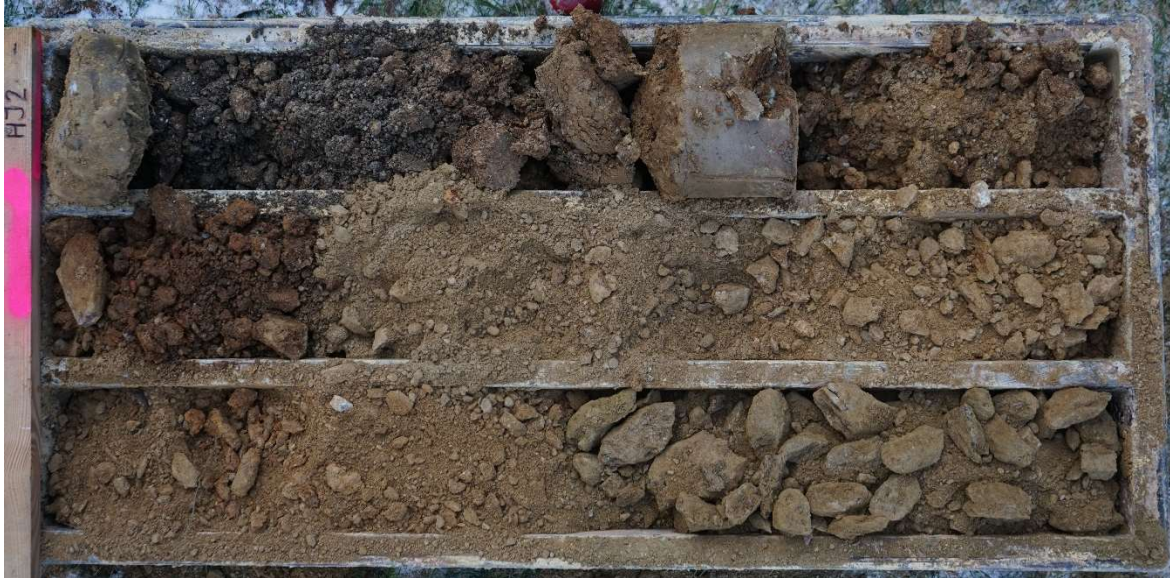
Obrázek 2 HJ2 – Fotodokumentace vrtného jádra
