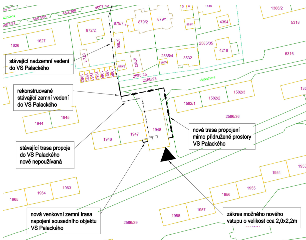
Obrázek 19 - nový vstup do strojovny VS Palackého (Příloha č. 14)
